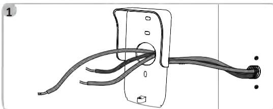
[2]. Przymocować osłonę przeciwdeszczową do ściany / słupa.
