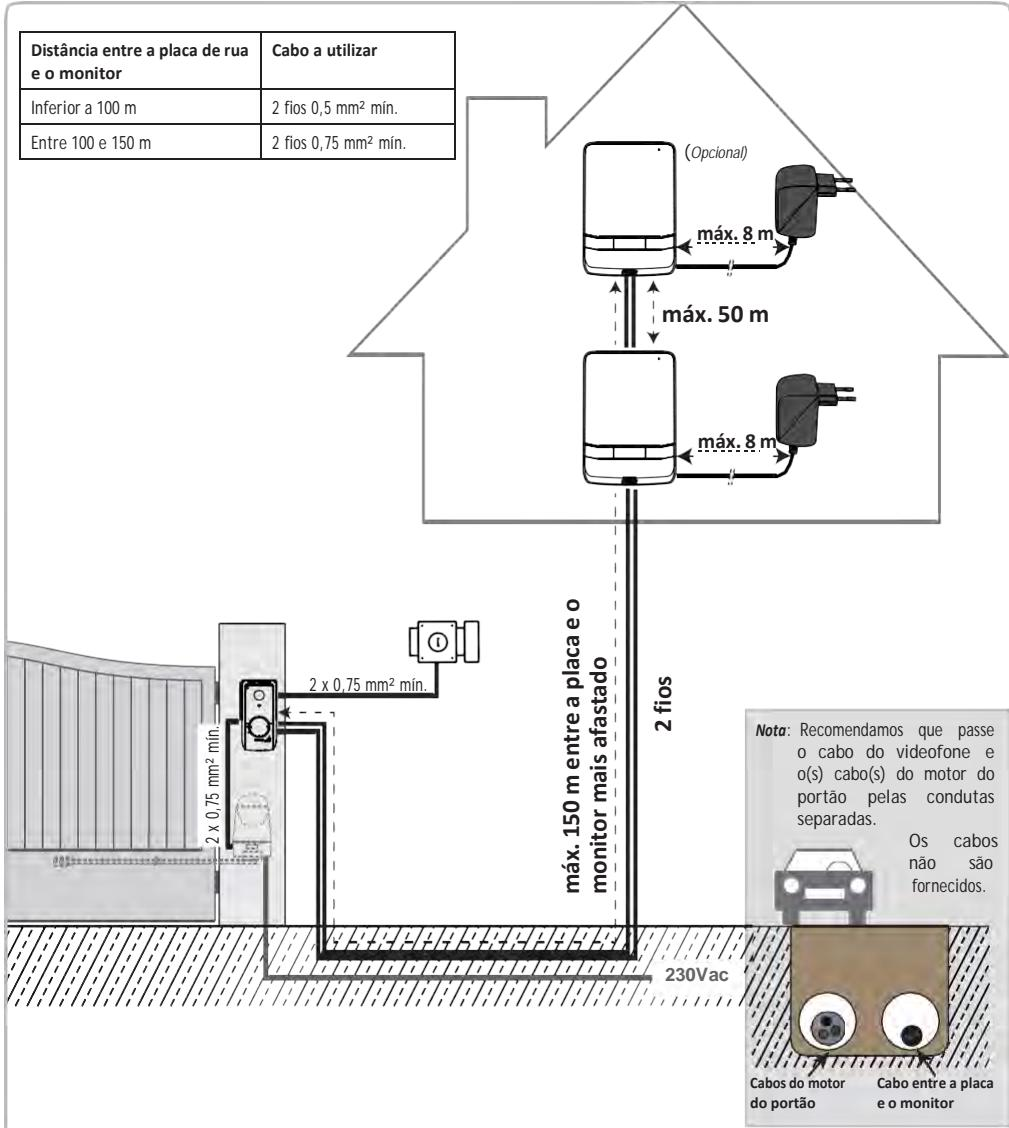
**Nota:** Se pretender utilizar caixas de derivação para ligar o videofone, não utilize mais de duas entre a placa e o monitor nem mais de uma entre o monitor e o módulo de alimentação.
