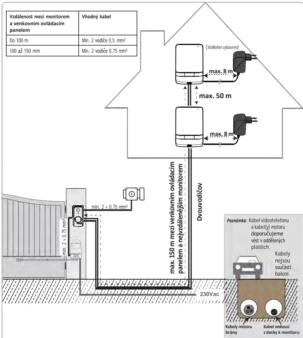
**Poznámka:** Musíte-li použít rozvodné skříně pro připojení videotelefonu, nepoužívejte mezi venkovním ovládacím panelem a monitorem více než dvě skříně a mezi monitorem a jednotkou síťového napájení více než jednu skříně.
