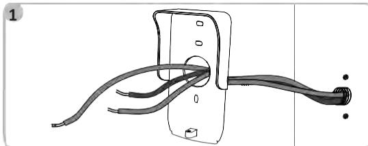
[2]. Montieren Sie die Regenschutzabdeckung an Wand/Pfeiler.
