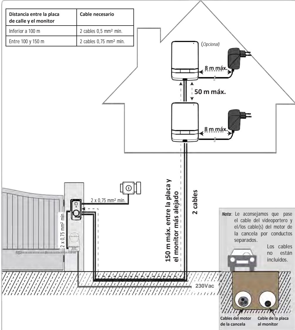
**Nota:** En caso de que deba utilizar cajas de derivación para cablear el videopuerto, no utilice más de dos cajas entre la placa y el monitor ni más de una caja entre el monitor y el adaptador de corriente.
