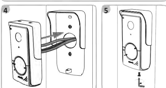
[5]. Przykręcić panel zewnętrzny do osłony przeciwdeszczowej przy pomocy dostarczonego klucza trzpiennego tamper Torx.
