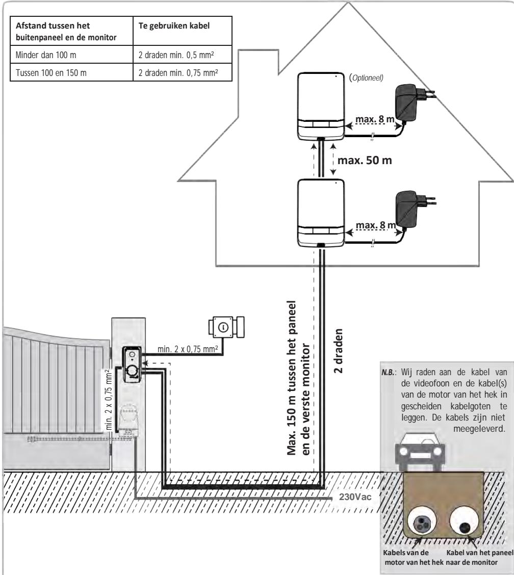
**N.B.:** Als u lasdozen gebruikt voor de bekabeling van de videofoon, gebruik er dan niet meer dan twee tussen het paneel en de monitor en niet meer dan een tussen de monitor en het netvoedingsblok.
