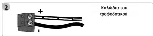
[3]. Συνδέστε το φις του τροφοδοτικού στην πίσω πλευρά της οθόνης στο DC, με τη φορά που επισημαίνεται στο σχήμα (βίδα προς τα δεξιά). Η φορά σύνδεσης των καλωδίων του τροφοδοτικού έχει σημανία.
