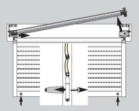
Enlever le support embout et le support treuil. Ne pas démonter les équerres existantes.
