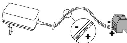
**[3].** Branchez le connecteur du bloc secteur à l'arrière du moniteur sur le bornier 5-1 dans le sens indiqué sur l'illustration (vis vers la gauche); le sens de connexion des fils du bloc d'alimentation est important.
