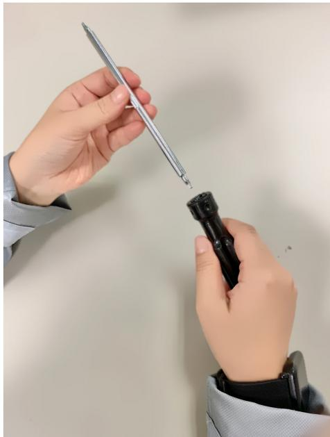
Veuillez utiliser le tournevis fourni pour serrer / desserrer les vis à six pans creux.
