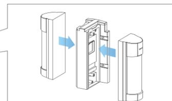
ATTENTION:: Le support T ne peut pas être utilisé pour 2 détecteurs hyperfréquence. DAM-DAM, DAM-RDAM, RDAM-RDAM.
