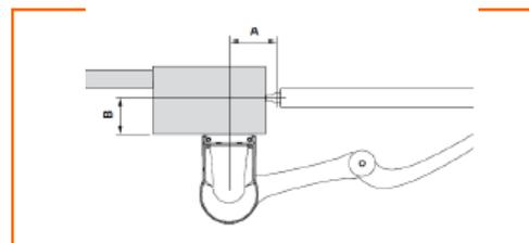
En fonction de la valeur de « B » et de l'angle d'ouverture désiré des battants , on peut trouver dans le tableau ci –contre la valeur de « A » ( distance entre le centre de la fixation sur le pilier et l'axe de rotation du portail).
