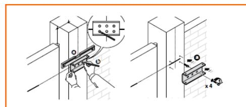
Monter l'opérateur sur la plaque fixée au pilier à l'aide des vis et des écrous auto freinés à bague nylon
