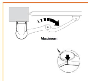
Ouvrir les deux battants jusqu'à la position désirée. Mettre ensuite la pièce de fin de course en butée avec le bras et visser la vis M8.
