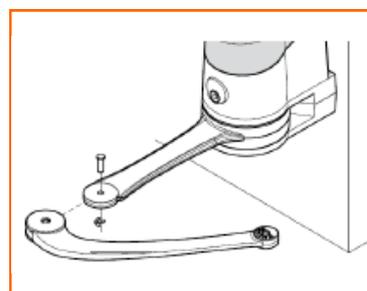
Fermer le portail, déverrouiller les opérateurs puis positionner la patte de fixation du bras au vantail au point le plus éloigné possible du pilier en allongeant au maximum les bras. La fixer au moyen de vis adaptées au matériau du vantail.
